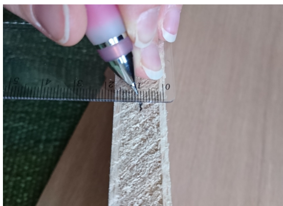
③板幅の面にも同じ間隔で正確に印を書いています。
